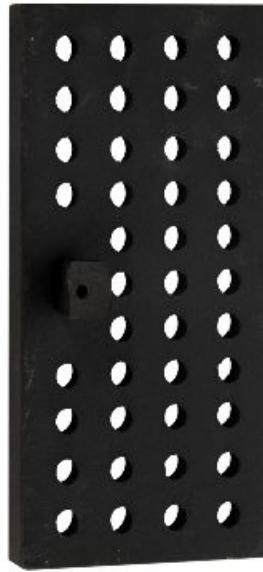
Rošty dodáváme přednostně ze žárobetonů. Žárobetonové rošty podporují lepší vyhoření paliva - a tedy menší uplavání otvorů v roštu.
