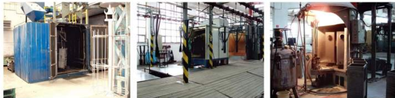
Pískování povrchu, galvanické pokovování a smaltování
