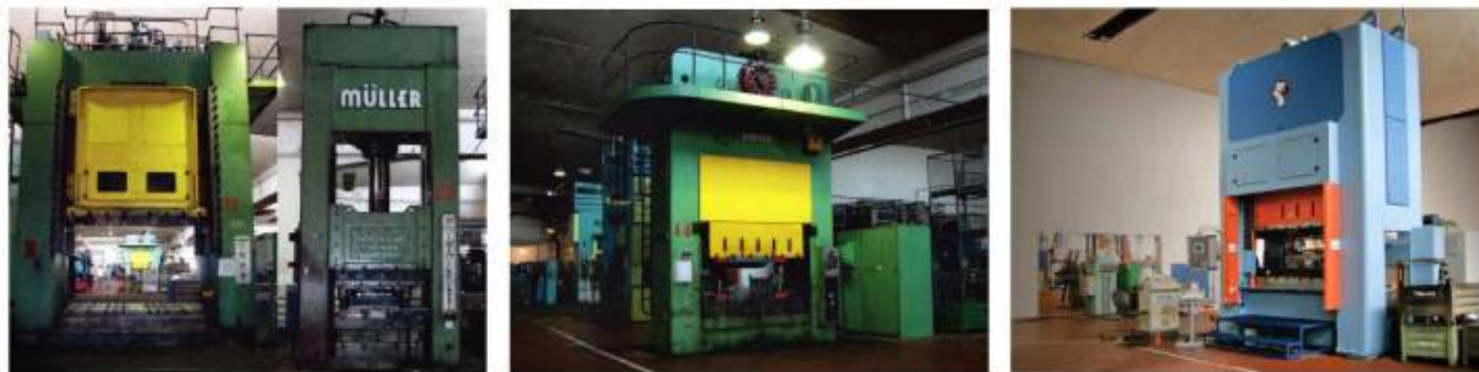
Lisování - stříhání a hohybání, hluboké tažení a protlačování
