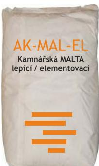
Kamnářská lepící malta je určena pro sezdívání a lepení žáruvzdorných materiálů (šamot, keramika atd.) do teplot 1000°C. Připravuje se vždy jen takové množství, které jste schopni zpracovat do 10 min. Malta se nanáší na tuhý podklad zbavený prachu a nečistot, při teplotě od +5 do +25 °C.
